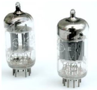
Röhren: Verstärker für Radios, können auch als Schalter im Computer verwendet werden.
