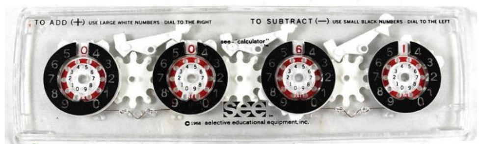
Digitalrechner benutzten früher Zahnräder und Hebel. Diese Addiermaschine funktioniert ähnlich wie die 1623 von Schickard konstruierte.
