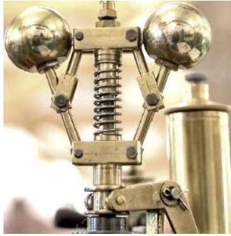
Ein Fliehkraftregler arbeitet analog , d.h. er öffnet oder schließt stufenlos ein Ventil.
