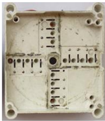
Im Gehäuse darunter befinden sich Taster, die von den Nocken herabgedrückt werden.
