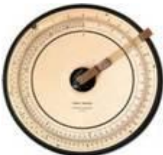
Analogrechner funktionierten mit verschiebbaren Skalen.
