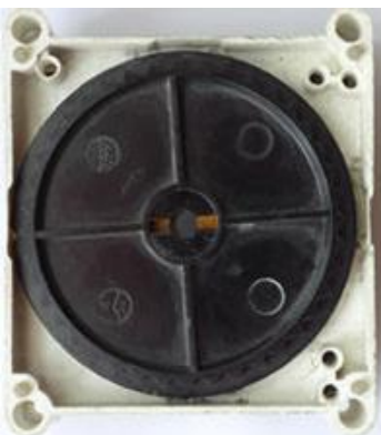
Der Programmschalter einer Waschmaschine: Ein Motor dreht langsam eine Scheibe.
