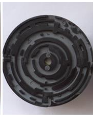
Betrachtet man die Unterseite der Scheibe, so entdeckt man Rillen und Nocken.
